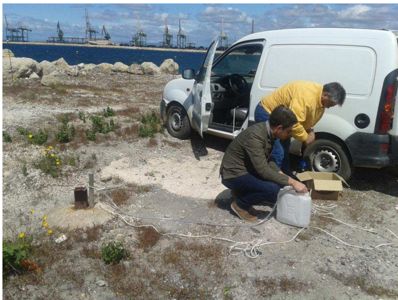
Figura 3.11: prelievi di acque di falda per test di trattabilità
